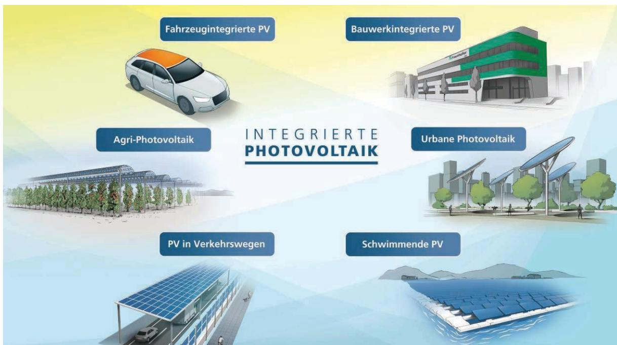
**Abbildung 28: Anwendungen für die Integration von Photovoltaik.**
