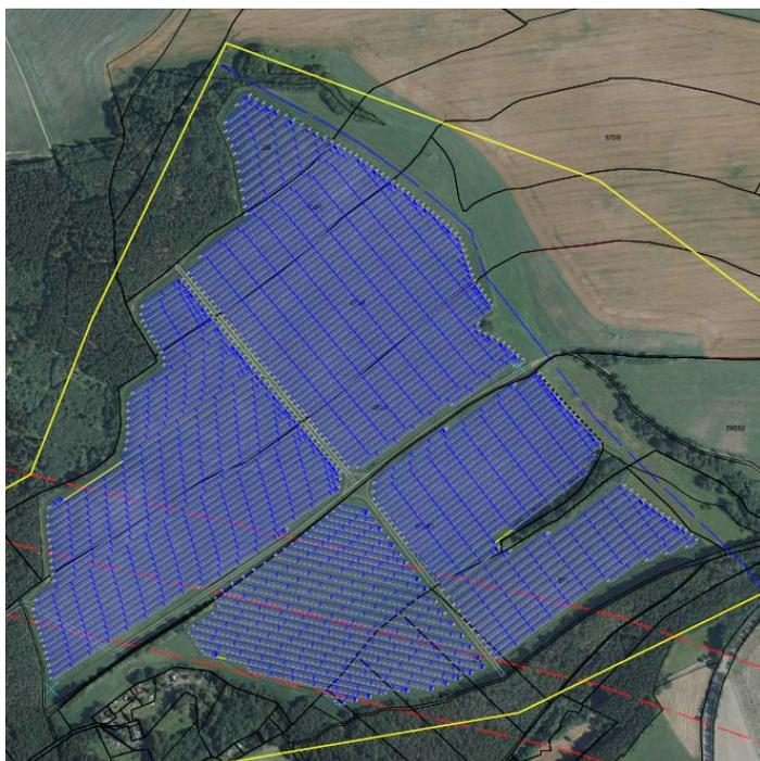
Abb. 2 Darstellung der Modulaufstellung, Quelle: M. Münch Auszug aus dem Modulplan
