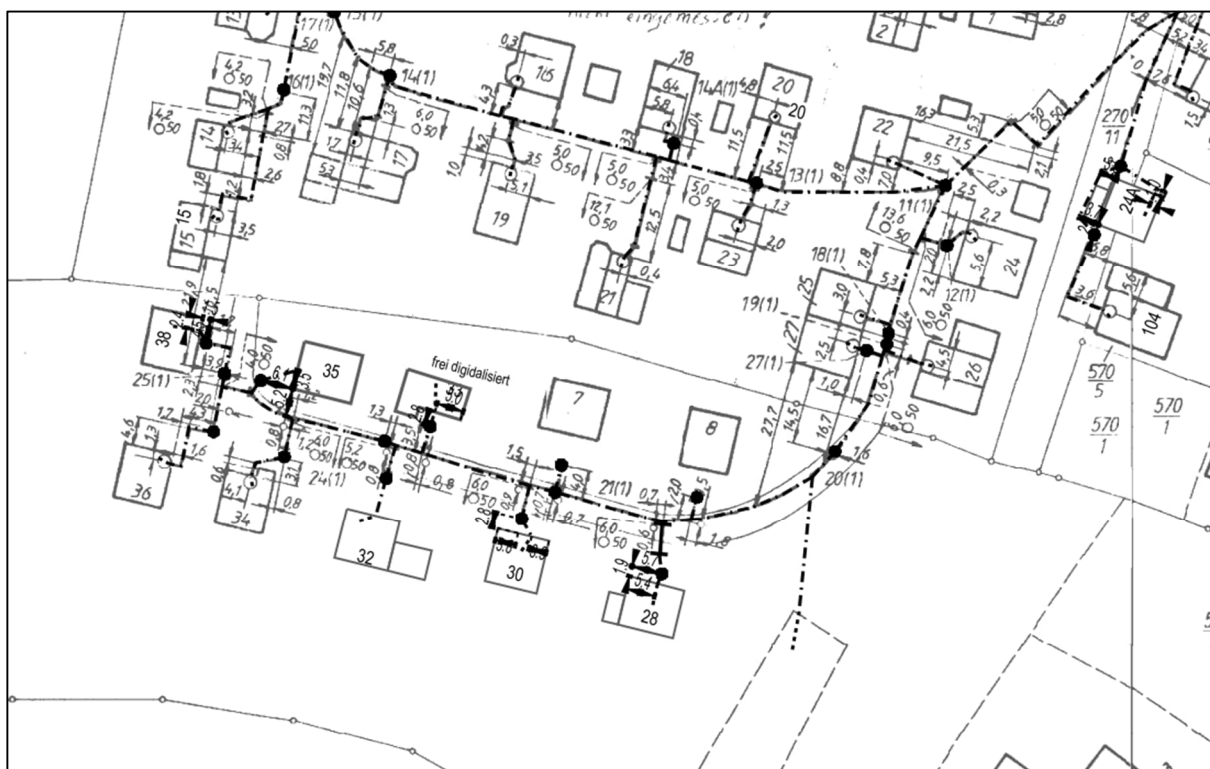
Abbildung 3: Lageplan Leitungsbestand Telekom
