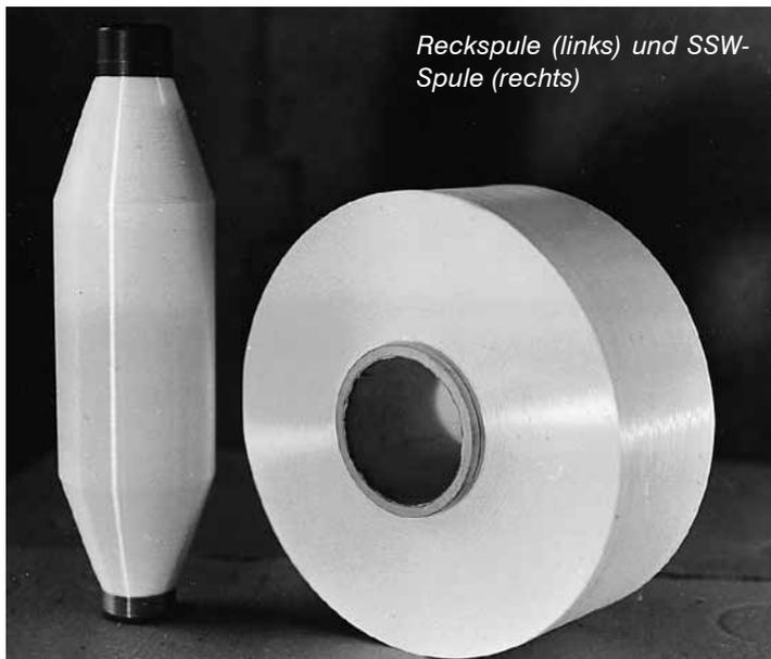
Reckspule (links) und SSW-Spule (rechts)
